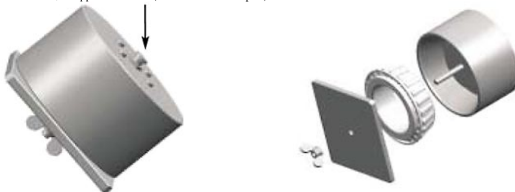
Smørenippel DIN 3404 (DIN 71412 via adapter).
